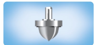
parabelförmiger Ventiltstößel ermöglicht hubproportionale K_v -Änderung
